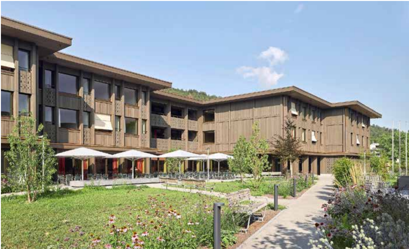
Generationenhaus Bad Zurzach: Zugunsten ihrer Langlebigkeit ist die Fassade aus Weisstanne druckimprägniert (KDS chromfrei mit braunem Farbton). Das grosse Vordach trägt zu ihrem Schutz bei. BILDER ROLAND BERNATH, ZÜRICH
